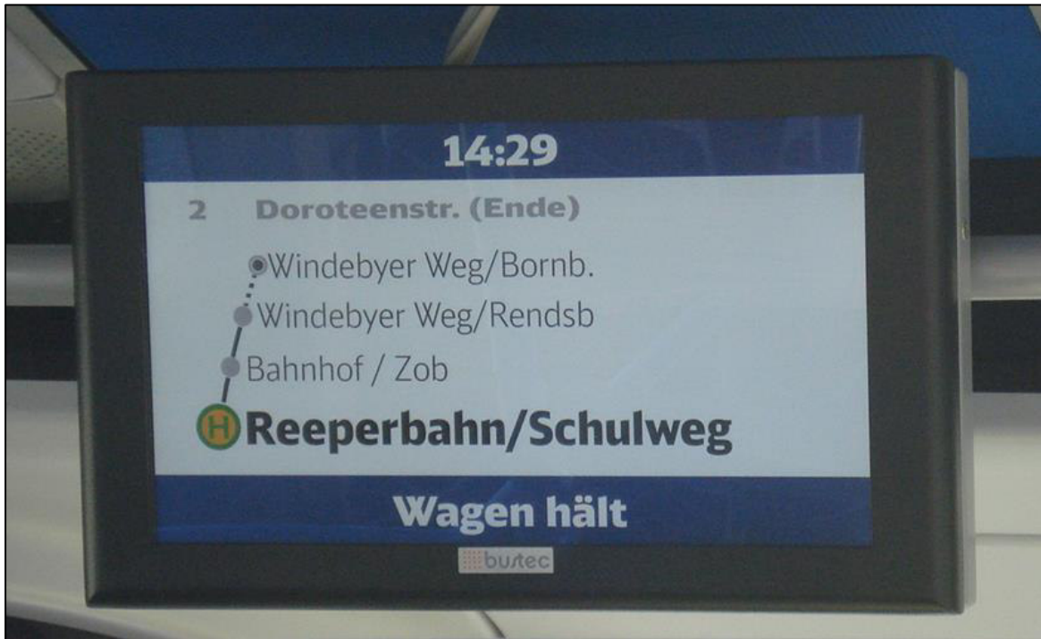
Abb. 31: Beispiel für gut lesbare TFT-Innenanzeige (Stadtverkehr Eckernförde – Quelle: eigene Aufnahme des Verfassers)
