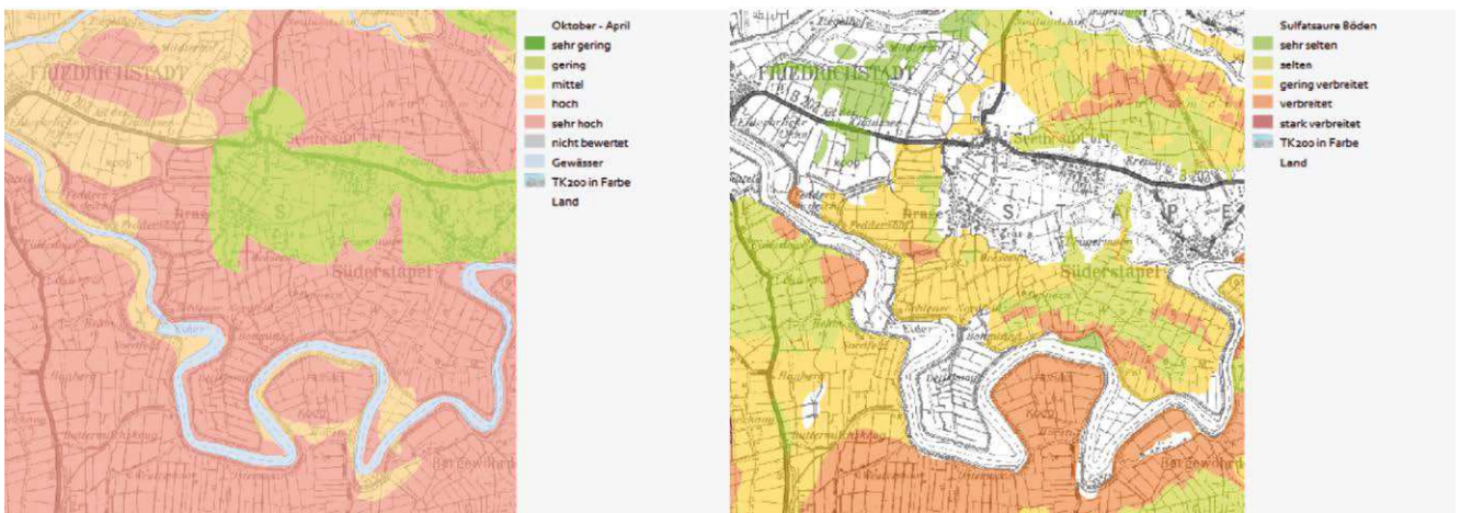
Abb. 3: Empfindlichkeit der Böden: Ausschnitt aus der Karte zur Bewertung der Verdichtungsempfindlichkeit (links) und aus der Karte der sulfatsauren Böden 1 : 250.000 (rechts)
